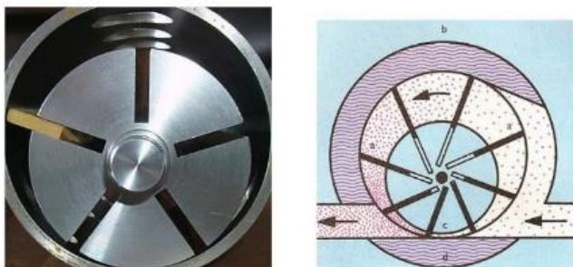
Лопатевий компресор
